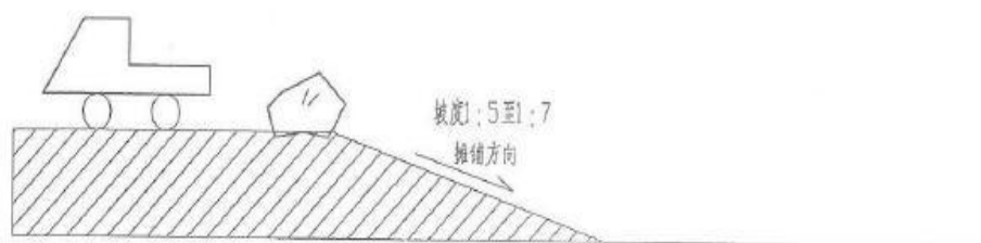
图 3-2-3 粉煤灰摊铺作业方法示意图（下推法）
